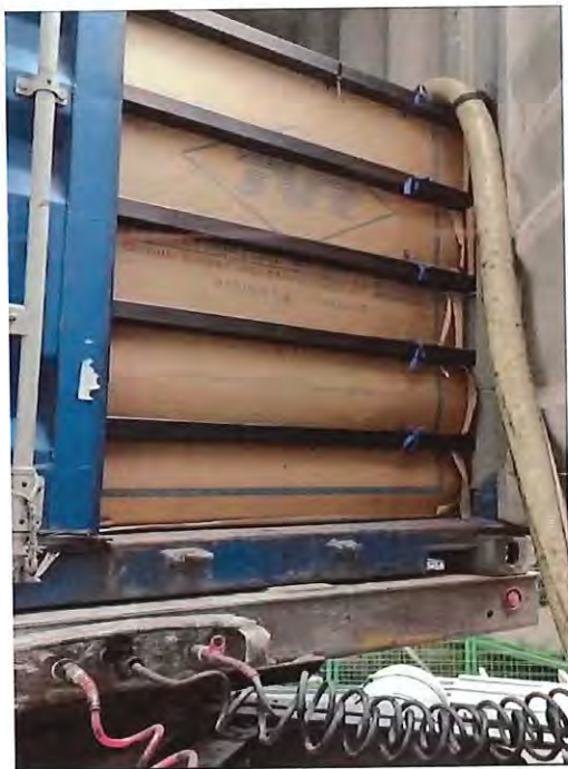
รูปที่ 1 ตัวอย่าง Flexibag ในการขนส่งน้ำยางพารา
